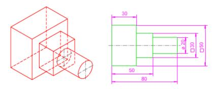
En la imagen superior te mostramos el dibujo isométrico de una pieza con sus vistas diédricas (alzado y planta) acotadas. Tienes que determinar si dicha acotación se ajusta a las normas explicadas en este apartado
