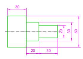
En la imagen superior te mostramos el dibujo isométrico de una pieza con sus vistas diédricas (alzado y planta) acotadas. Tienes que determinar si dicha acotación se ajusta a las normas explicadas en este apartado.
