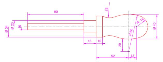
En la imagen superior te mostramos una pieza acotada. Tienes que determinar si dicha acotación se ajusta a las normas explicadas en este apartado y los anteriores.
