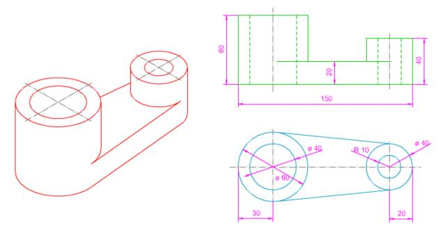
En la imagen superior te mostramos el dibujo isométrico de una pieza con sus vistas diédricas (alzado y planta) acotadas. Tienes que determinar si dicha acotación se ajusta a las normas explicadas en este apartado.
