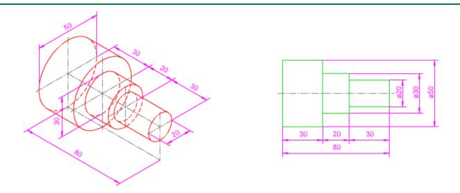
En la imagen superior te mostramos una pieza de revolución cilíndrica según sus representaciones isométrica, perfil derecho, y diédricas acotadas en serie.
