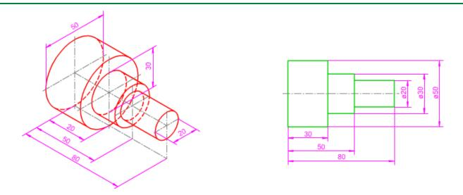
En la imagen superior puedes ver una pieza de revolución cilíndrica según sus representaciones isométrica, perfil derecho, y diédricas acotadas en paralelo.
