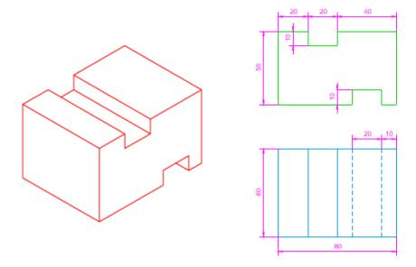
En la imagen superior te mostramos el dibujo isométrico de una pieza con sus vistas diédricas (alzado y planta) acotadas.
