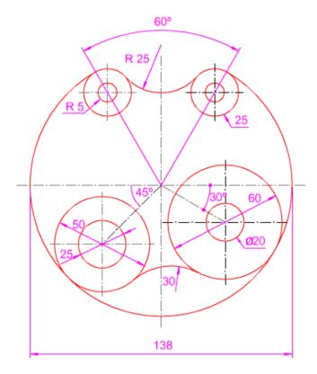
En la imagen superior te mostramos una pieza acotada. Tienes que determinar si dicha acotación se ajusta a las normas explicadas en este apartado y los anteriores.
