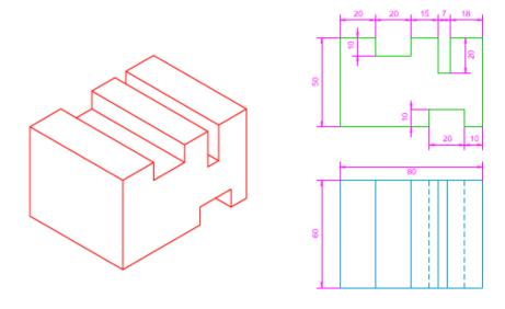
En la imagen superior te mostramos el dibujo isométrico de una pieza con sus vistas diédricas (alzado y planta) acotadas. Tienes que determinar si dicha acotación se ajusta a las normas explicadas en este apartado.
