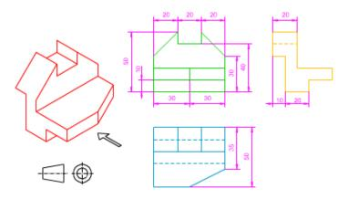
En la imagen superior te mostramos el dibujo isométrico de una pieza con sus vistas diédricas (alzado, planta y perfil izquierdo) acotadas. Tienes que determinar si dicha acotación se ajusta a las normas explicadas en este apartado.
