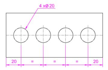
Los elementos dispuestos linealmente se acotan simplificando sus cotas de referencia lineal idénticas mediante el símbolo =. Se anota la cota de un sólo elemento y se señala el número de ellos.
