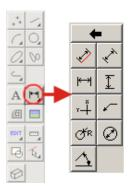
La acotación en QCad se realiza con una serie de herramientas accesibles mediante el botón de acotación de la barra principal de herramientas.
